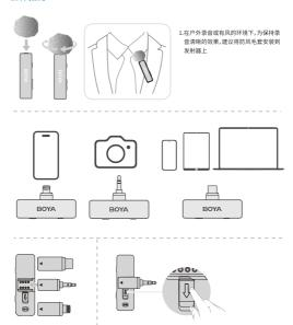
2.选择适配的转接头安装到接收器的凹槽,然后连接至相机、手机、平板、或电脑等设备。
